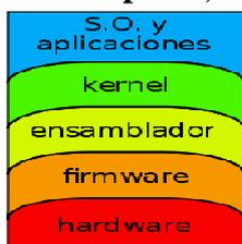
Una visión típica de la **arquitectura de computadores** como una serie de capas de abstracción: **hardware**, **firmware**, **ensamblador**, **kernel**, **sistema operativo** y **aplicaciones**.
