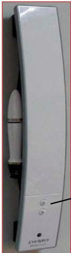
Una vez que está todo preparado, resta realizar la calibración. Presionamos el botón superior del dispositivo amurado a la pared y vamos tildando con el lápiz digital las 9 “equis” que nos irán marcando en pantalla.
