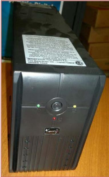
El carro, a su vez, viene equipado con una **Unidad de Potencia Auxiliar (UPS)**; se trata de una batería, que en caso de un corte de luz repentino, le dará al docente unos 10 minutos extras de energía para poder apagar el **Servidor** correctamente (es decir, desde el botón de Inicio, y luego Apagar Sistema).
