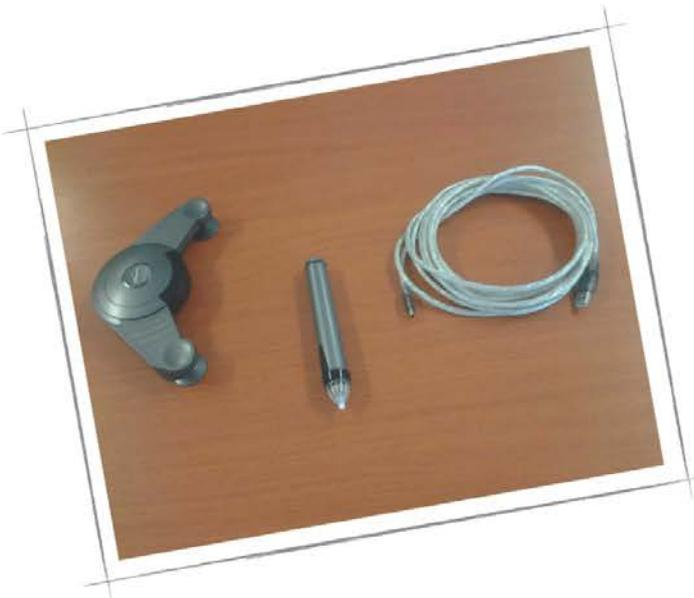
Los elementos que integran la pizarra digital (e-beam) son el generador del campo de acción de la misma, un lápiz óptico y el cable de conexión a una net-book...
