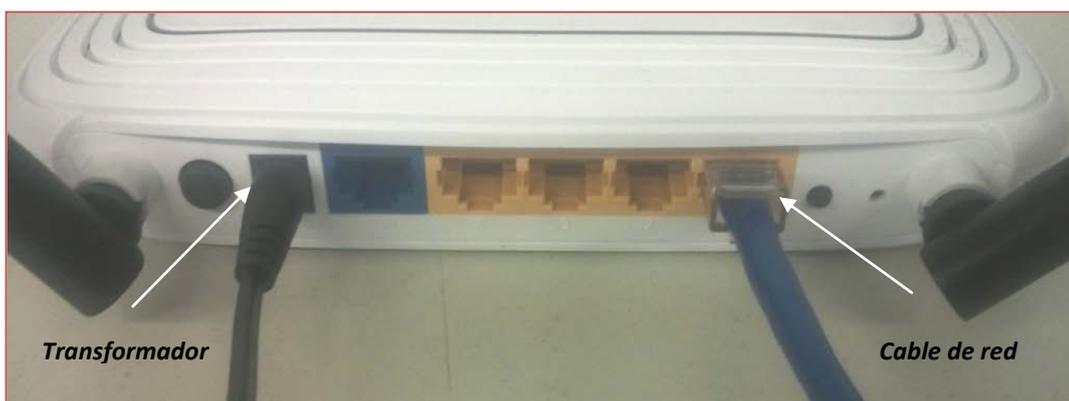
**Imagen 13 – Vista posterior del Router Inalámbrico**
